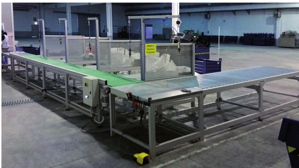
Esempio di linea per il disassemblaggio di monitor e TV
