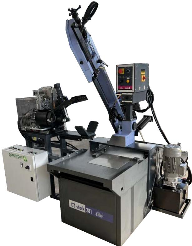
COMPRESSOR è un sistema semi automatico per il taglio dei compressori refrigeranti che derivano dai frigoriferi e dai congelatori. Il macchinario esegue un taglio lungo la circonferenza della calotta superiore del compressore per consentire la successiva estrazione manuale del motore elettrico contenuto ed eliminare eventuali residui di olio.
